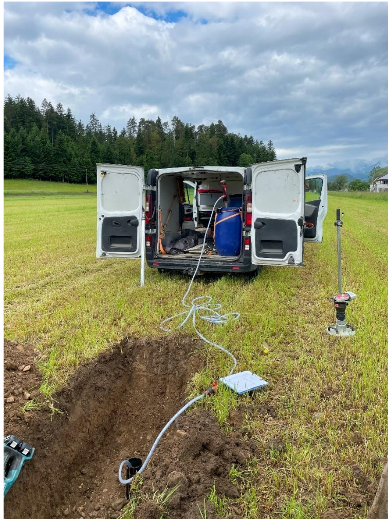
Slika 10: Izvajanje nalivalnega poizkusa s črpalko
